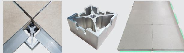
전시부스 고급화를 위해 바닥 단은 주로 목공으로 제작, 설치, 폐기되고 있어 시간과 비용이 많이 발생하고 있습니다. E-System은 이런 문제점들을 보완하여 전시장 내, 외부에서 사용할 수 있도록 개발되었습니다. 바닥 수평을 육각렌치 하나로 조절이 가능하고, 초보자도 손쉽게 설치, 해체, 철수가 가능하며 운송과 보관이 용이한 시스템 입니다. 또한 사용자가 원하는 공간에 맞춘 프레임 설치 가능하고 PVC타일, 타일카페트, 강화유리, 롤카페트, 간접조명 등 다양한 마감재 적용이 가능하며 바닥공간에 전기, 인터넷, 에어, 급배수 라인을 자유롭게 설치 가능합니다. E-System은 소비자가 원하는 다양한 심미성을 연출할 수 있는 제품이며 독창적이고 차별화된 제품으로 재활용이 가능한 친환경 제품입니다.
